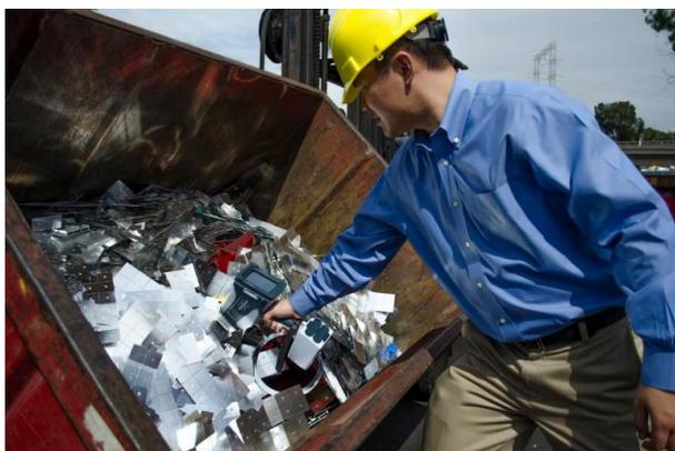
► L'analyseur XRF permet aux broyeurs de détecter en quelques instants la composition chimique d'un métal à l'aide d'un rayon X projeté. Outil idéal pour les PMI\*, contrôles qualité et analyse de métaux non-ferreux
