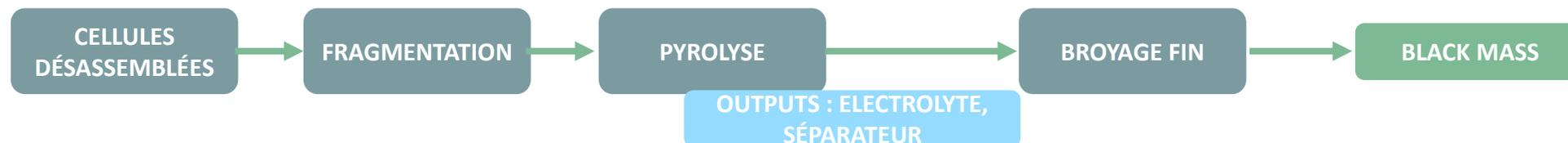
En revanche, le tri par traitement thermique ajoute une étape de pyrolyse à haute température après la fragmentation initiale. Ce processus permet d'éliminer l'électrolyte et le séparateur par désorption thermique avant le broyage fin. L'azote (N<sub>2</sub>) est introduit pour assurer la protection contre les explosions et les incendies.
