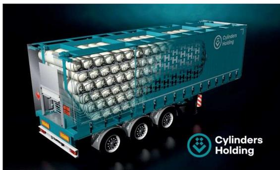
Exemples de semi-remorques pour le transport d'hydrogène comprimé
