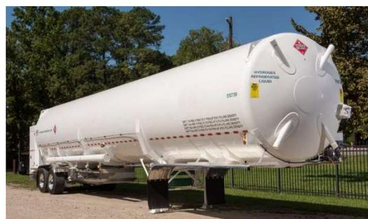
Exemples de semi-remorques pour le transport d'hydrogène liquide
