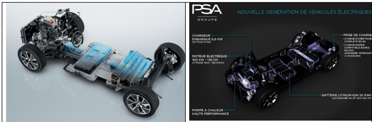
Figure 5: architecture électrique de la plateforme e-CMP du Groupe PSA<sup>11</sup>
